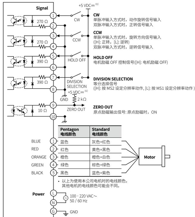
01) 当外部的信号输入超过 +5 VDC 时，请在外部连接电阻。
