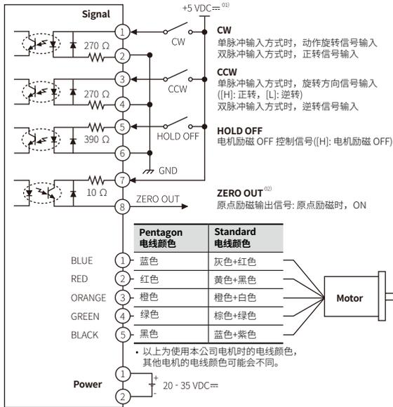
01) 当外部的信号输入超过 +5 VDC 时，请在外部连接电阻。
