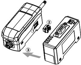
拆除想要连接的放大器单元的侧面盖 (①) 后，再结合侧面连接器 (②)。将放大器单元和通信转换器安装在 DIN rail 后，按箭头方向 (③) 紧密安装。
