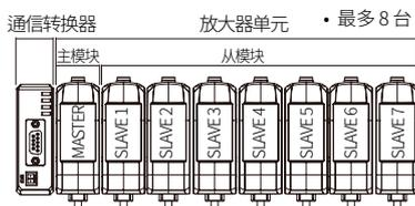
输入/输出电线引出方向朝下时，最左侧的放大器作为主模块动作，通道编号从左到右依次递增。通信转换器位于主模块放大器的左侧。
