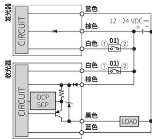
01) Picking Input (P.I.): 接点或晶体管 ON 时，则执行 Picking indicator 功能。
