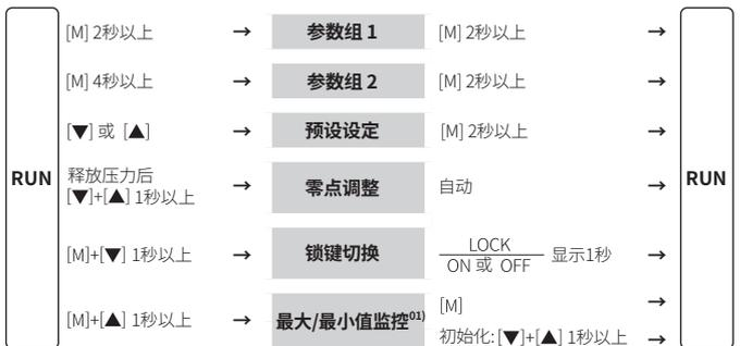
01) PV 显示器: 显示最大值, SV 显示器: 显示最小值
