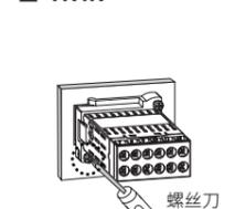
使用支架将产品安装在面板后, 使用螺丝刀将螺丝旋紧。
