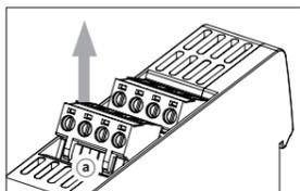
用工具(如：一字螺丝刀)向上抬起端子台单元下方的①部分。
