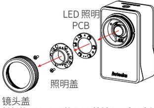
04. 将新的 LED 照明的 PCB 接触 PIN 朝6点钟方向，并将其安装在本体上。
