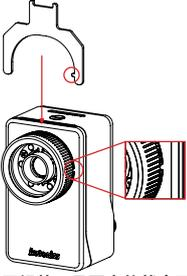
02. 用组装工具固定的状态下抓住镜头盖按逆时针方向将其拆除。
