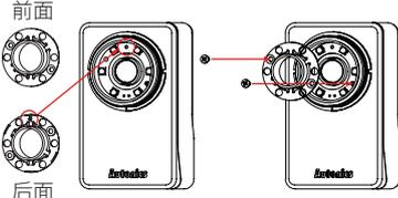
06. 顺时针方向安装拆卸的镜头盖。
