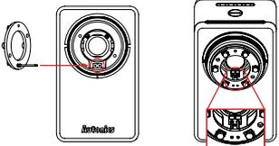
05. 照明盖对准12点钟方向卡入后，用螺丝进行固定。固定螺丝的扭矩为 0.12 N·m。
